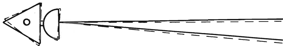
figura 2 - Effetto di una lieve torsione della struttura dell'antenna sulle zone marginali di irradiazione del segnale.
